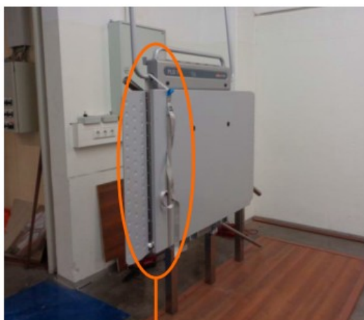
Při napínání nezapomeňte zvednout nájezdovou rampu a bariéru plošiny.
